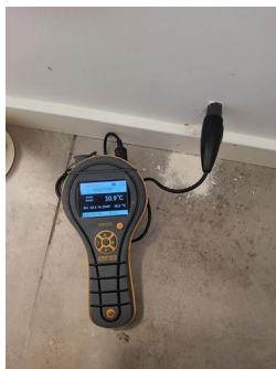
Utført kontroll i tiliggende konstruksjon - Relativ luftfuktighet.
