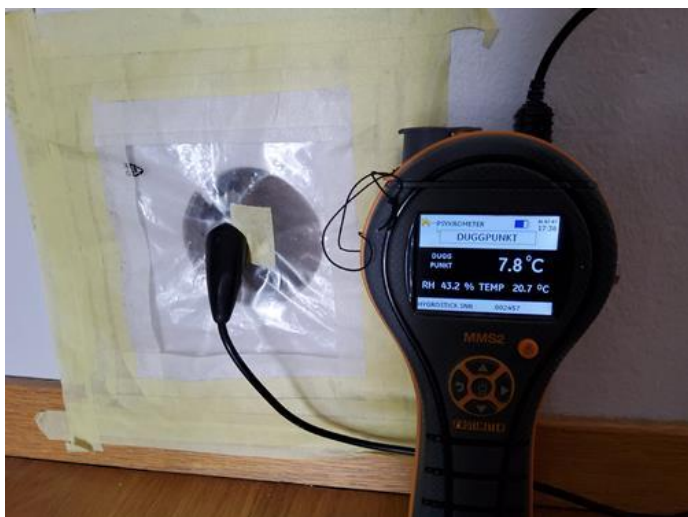
Kommentar - [Fuktmåling bad.]
