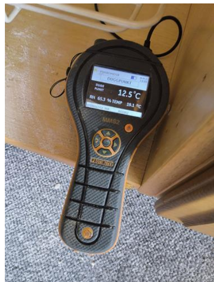
Fukt i tilliggende konstruksjoner - [Fuktmåling bad i leilighet]
