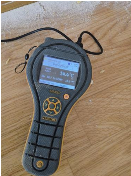
Konstruksjoner (tilfargerulv, himling og vegger). - [Fuktmåling kjellevegg]
