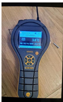
Utført kontroll i tilliggende konstruksjon - Fuktmåling
