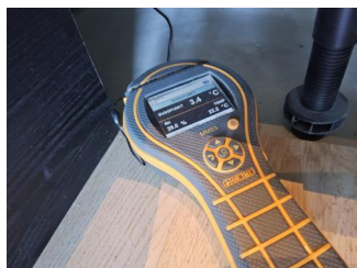
Utført kontroll i tiliggende konstruksjon - Fuktmåling bad 1.
