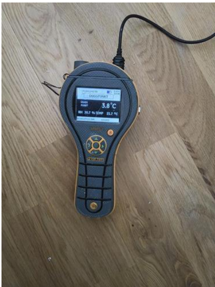
Fukt i tilliggende konstruksjoner - [Fuktmåling ]
