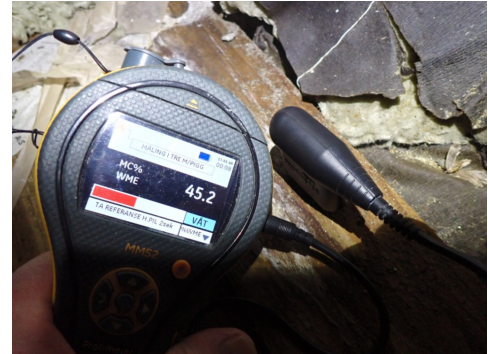
Fuktmåling i gulvbord ved pipa
