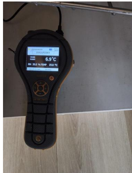
Fukt i tiliggende konstruksjoner - [Fuktmåling]
