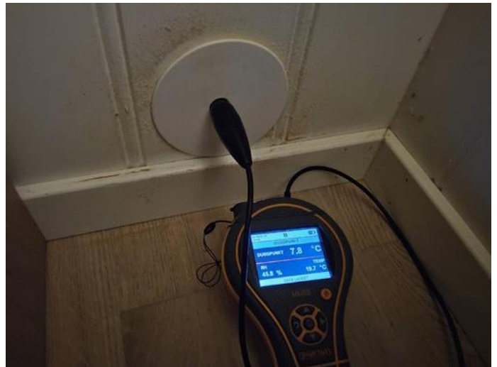
Konstruksjoner (tilfarergulv, himling og vegger). - [Fuktmåling i utlektet vegg i underetasje]
