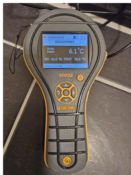
Fukt i tilleggende konstruksjoner - [Fuktmåling]
