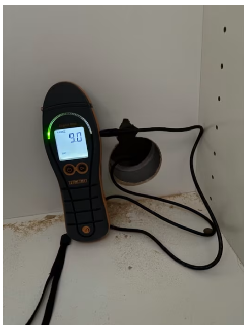
Hulltaking med fuktmåling fra tiliggende soverom2 mot våtsone, uten avvik.
