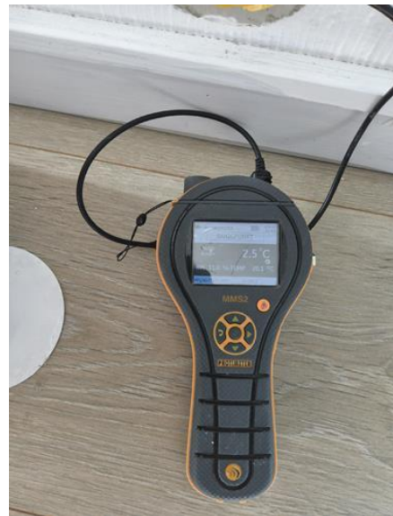
Fukt i tilleggende konstruksjoner - [Fuktmåling ]
