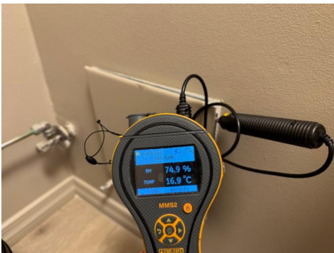
Måling av relativ luftfuktighet.
