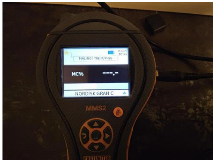
Våtrom - [Fuktmåling bad 1.etg.]
