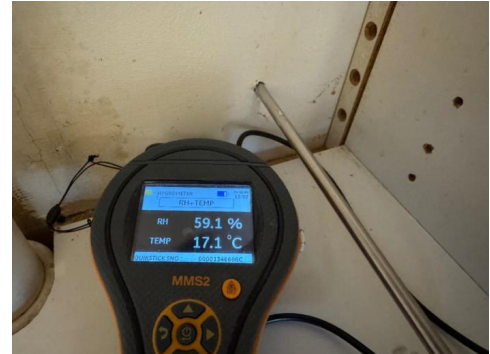
Måling av relativ luftfuktighet.
