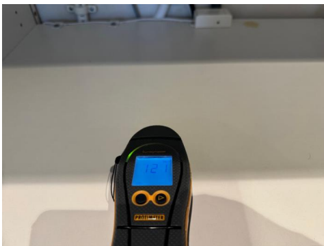
Ingen forhøyede fuktverdier ble registrert i kjøkkenbenken.
