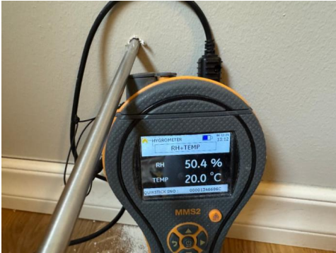
Måling av relativ luftfuktighet.
