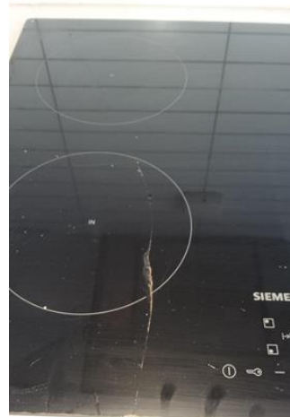
Innredning - [Sprekk i platetopp]
