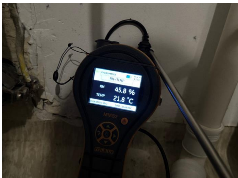
Måling av relativ luftfuktighet.
