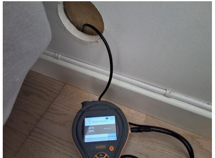
Våtrom - [Fuktmåling bad u.etg]
