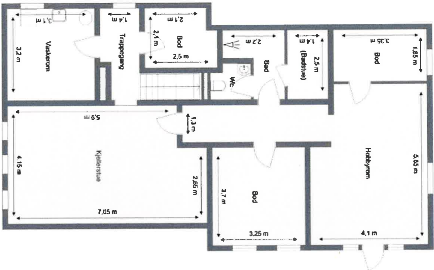
Existerande kjeller etasjen med mål, eksisterende situasjon
