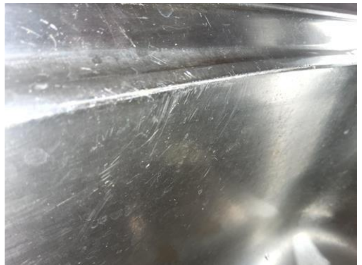
Innredning - [Sprekk i servant]
