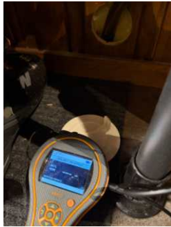
Måling etter fukt i vegg mot bad.
