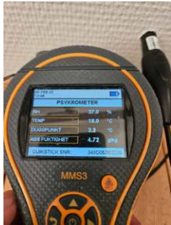
Måling av relativ luftfuktighet i utlekket veggkonstruksjon i stue under bakkenivå.
