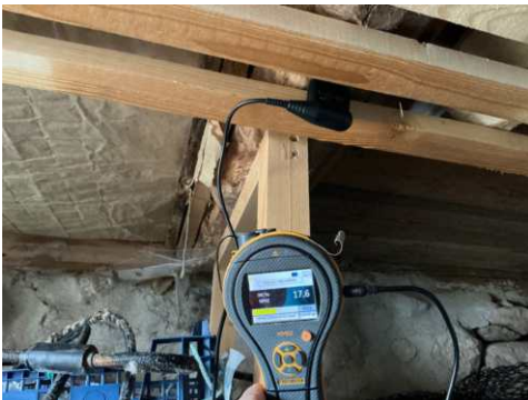
Moderate utslag registrert. Ofte normalt i denne type krypkjeller
