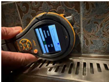
Fuktsøk på gulv og vegger.
