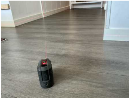
Nivellering kjellerstue + trapperom, ingen avvik registrert
