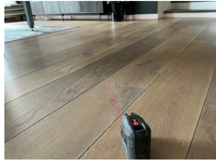
Nivellering stue, trapperom, ingen avvik registrert
