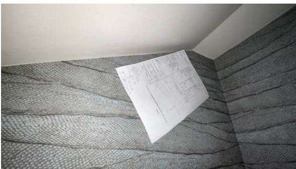
Test med løst ark viste tilfredsstillende avtrekk.
