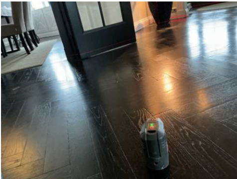
Nivellering stue + spisestue, avvik ca. 10-20 mm
