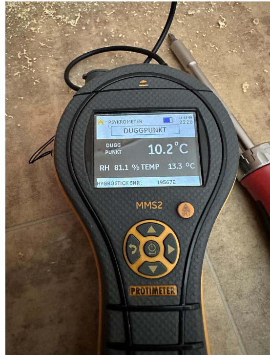
Måling på soverom i kjeller, her ble det målt høye fuktverdier.
