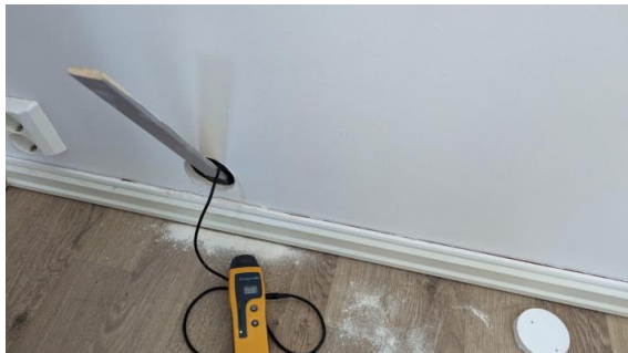
Fuktsøk i tilstøtende vegg til bad (fra soverom)
