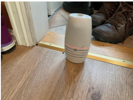
Måling av skjevhet/retningsavvik på gulv (hovedplan)
