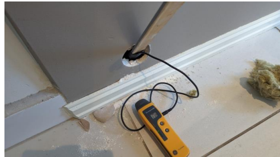
Fuktsøk i tilstøtende vegg til bad
