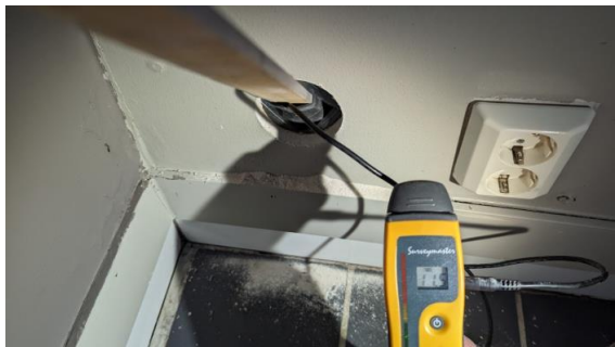
Måling av fukt i utforet vegg
