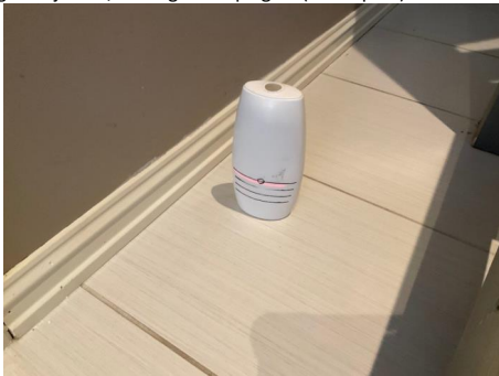
Måling av skjevhet/retningsavvik på gulv (u.etg)
