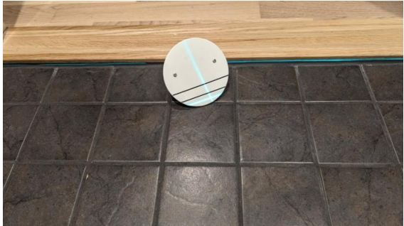
Måling av fallforhold på gulv mot sluksone
