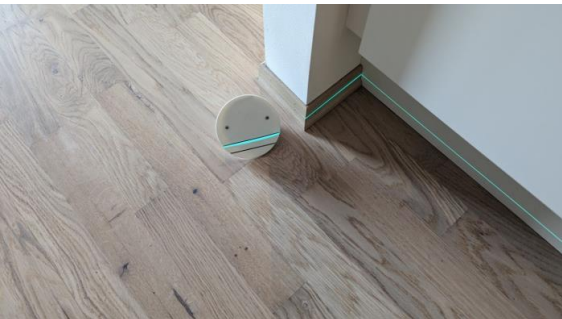
Måling av skjevhet/retningsavvik på gulv
