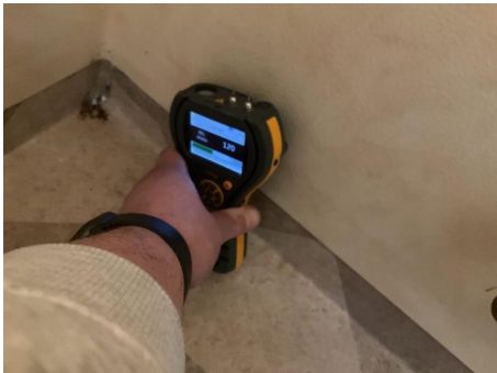
Fuktsøk med indikator viste ingen unormale verdier.
