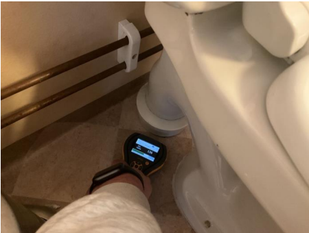
Fuktsøk med indikator viste ingen unormale verdier.
