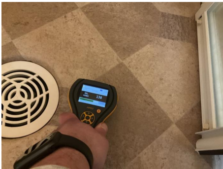
Fuktsøk med indikator viste ingen unormale verdier.
