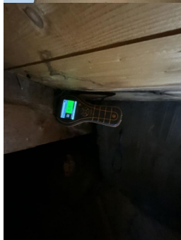
M ling i omr de hvor det er p vist tidligere fuktskade
