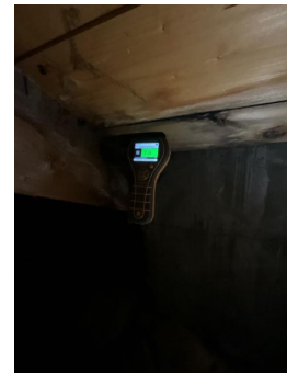
M ling i omr de hvor det er p vist tidligere fuktskade
