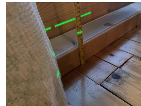
ikke funnet større høydeforskjeller i bjelkelag
