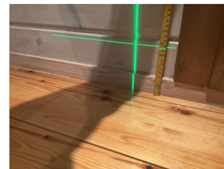
ikke funnet større høydeforskjeller i bjelkelag
