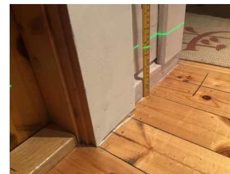
ikke funnet større høydeforskjeller i bjelkelag
