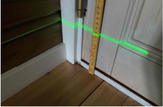
påvist noe høydeavvik på gulv i stue
