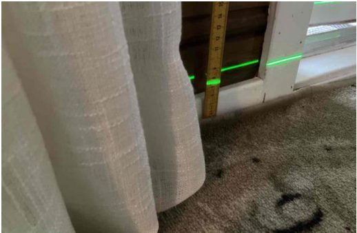
påvist noe høydeavvik på gulv i stue
