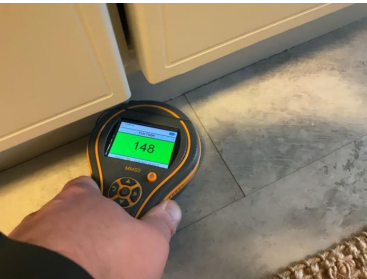
Ved bruk av fuktindikator registrerte jeg ingen forhøyede verdier.
