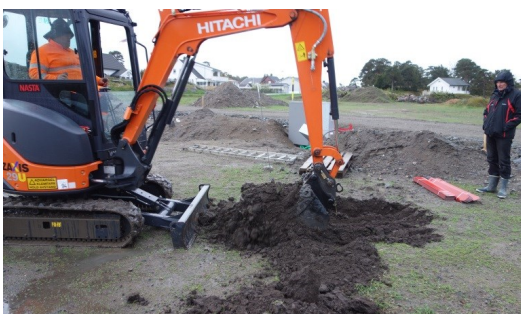
Bilde 3+4. Gravehull 2, sør for borehull 5. Jord over blandingsleire over leirig sandig silt, mindre stein.
