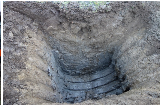
Bilde 1+2. Gravehull 1, sør for borehull 3. Fyllmasser over blandingsleire over leirig sandig steinig silt.
