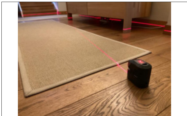
Nivellering hall, ingen registrerte avvik
